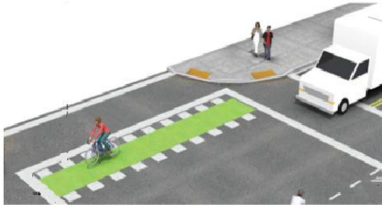
**Figura 39-3:** Señalética longitudinal intersecciones.
