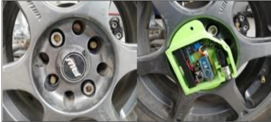
**Figura 19-3:** Placa de sensor de presión
