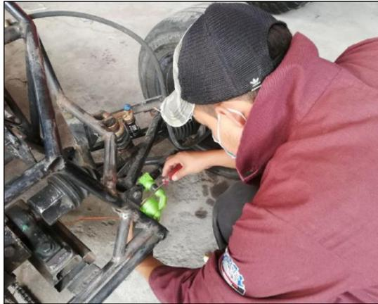
**Figura 2-4:** Fijación del sensor de suspensión
