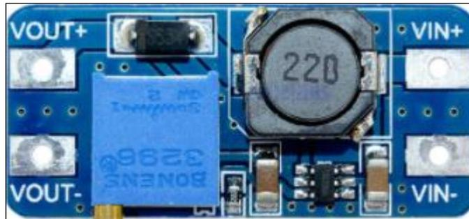
**Figura 10-3:** Convertidor de voltaje MT3608
