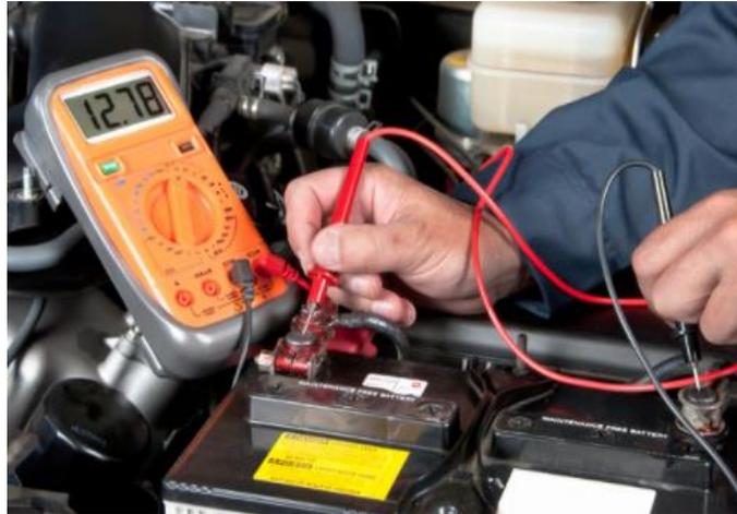
**Figura 13-2:** Mediciones de carga en batería
