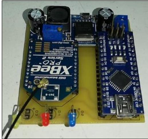
**Figura 25-3:** Tarjeta receptora de datos
