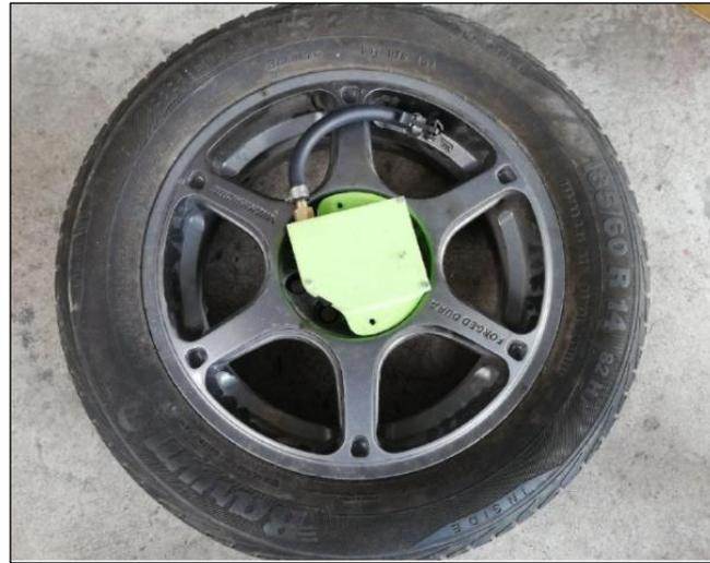
**Figura 14-4:** Implementación del sensor de presión
