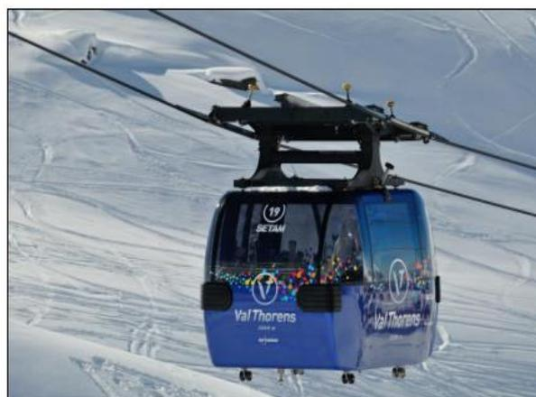
**Figura 7-1.** Teleféricos mono cables de doble anillo
