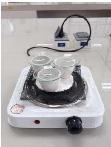
Crisoles cubiertos por un vidrio reloj en el proceso de cenizas solubles en agua
