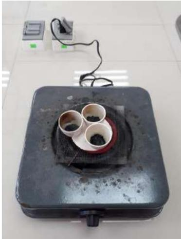
Carbonización de las muestras para determinación de cenizas totales
