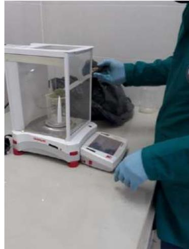
Pesaje del material vegetal para preparación del extracto hidroalcohólico
