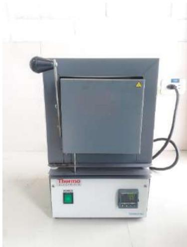
Mufla a 700 °C para la determinación de cenizas insolubles en ácido clorhídrico
