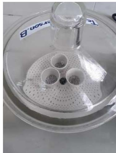
Crisoles en el desecador para el proceso de cenizas solubles en agua
