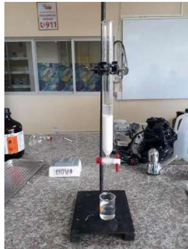
Preparación de la fase móvil para cromatografía en columna
