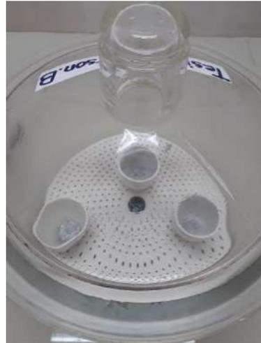
Crisoles en el desecador para la determinación de cenizas insolubles en ácido clorhídrico
