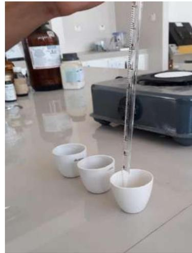
Adición de 15 ml de agua a las C.T. para determinación de cenizas solubles en agua
