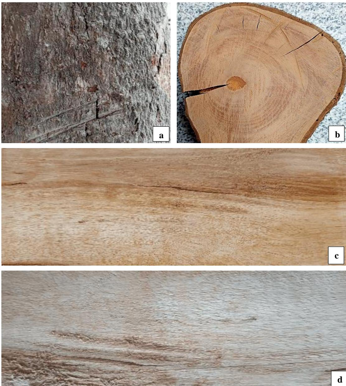
**Figura 16-3.** a. corteza; b. S. Transversal; c. S. Tangencial; d. S. radial de *Clusia multiflora*
