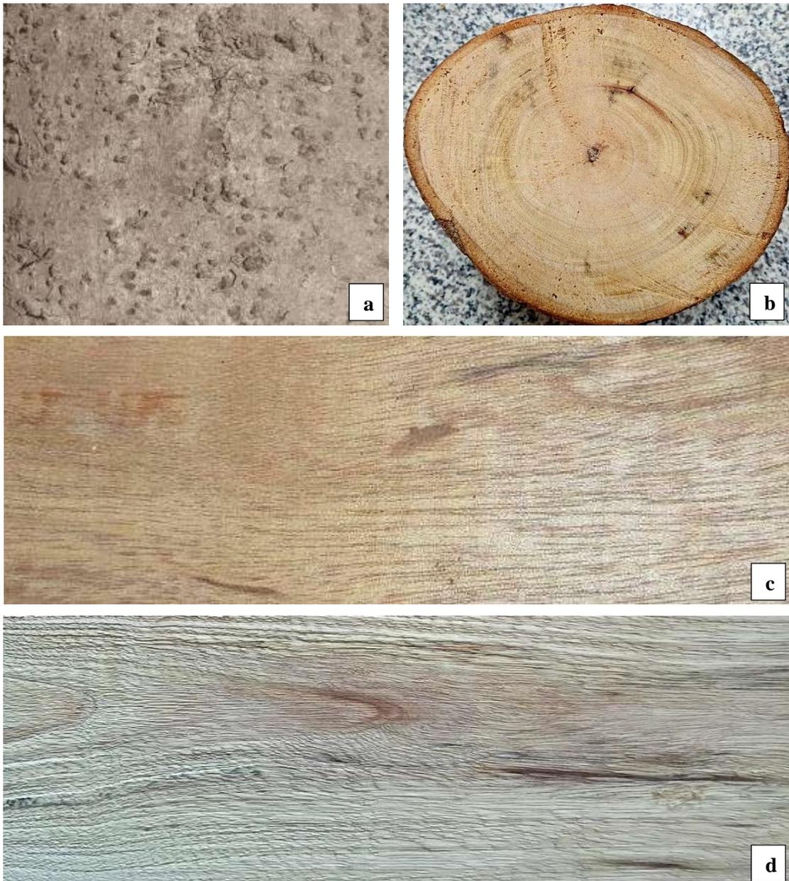
**Figura 19-3.** a. Corteza; b. S. Transversal; c. S. tangencial; d. S. radial de *Nectandra membranacea*
