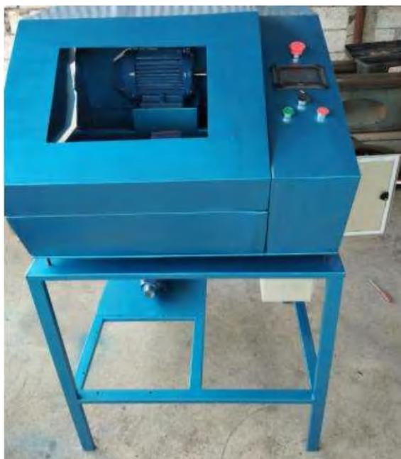
**Figura 1-4.** Cortadora de materiales ferrosos y no ferrosos
