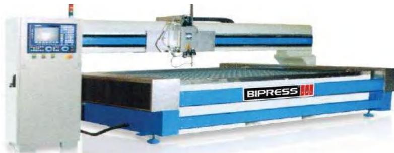
**Figura 1-2.** Cortadora por chorro de agua
