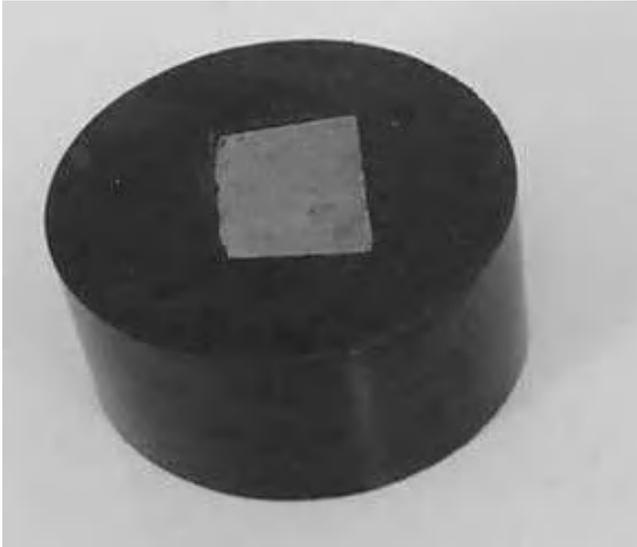
**Figura 2-3.** Montaje de la probeta
