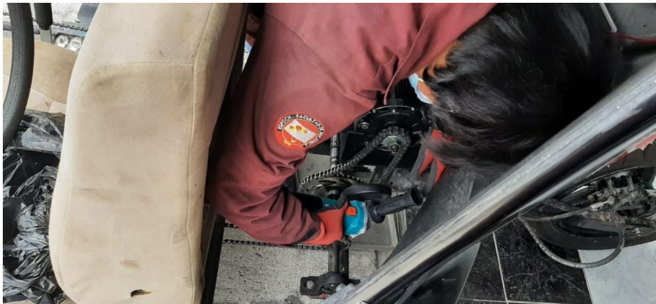
Figura 15-3: Ensamble de cadena entre el motor y el eje de tracción.
