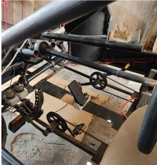
Figura 16-3: Ensamble de pedal de acelerador
