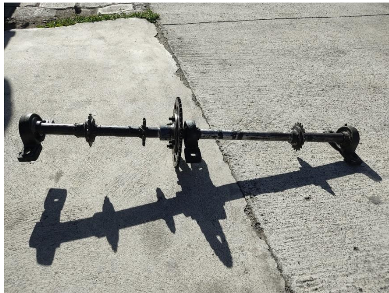
Figura 11-3: Ensamble de catalinas y piñones en eje de tracción
