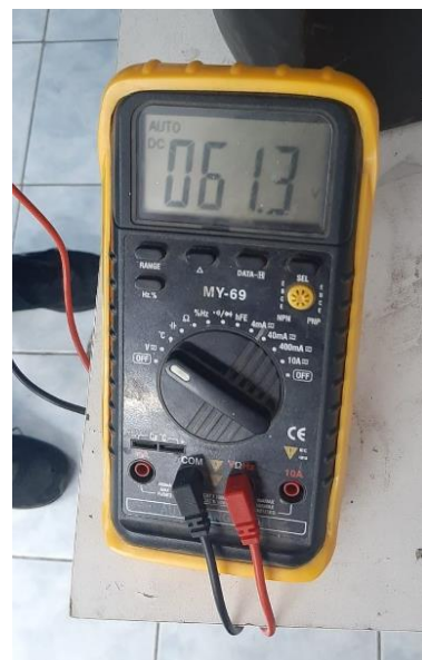
Figura 8-4: SOC mínimo de batería
