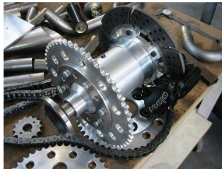
Figura 6-2: Transmisión por cadena
