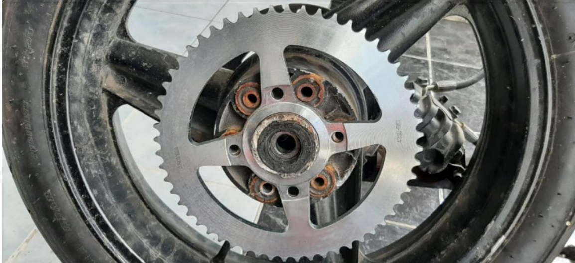
Figura 14-3: Instalación de catalina en la rueda de tracción.
