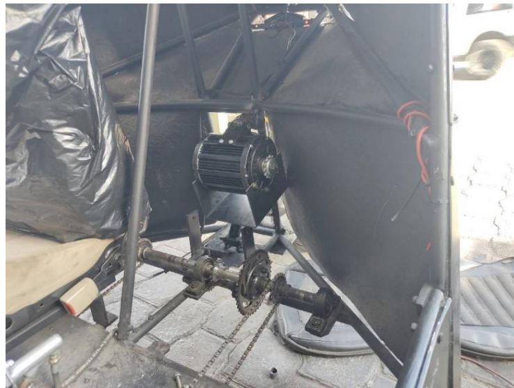
Figura 13-3: Ensamble de base de motor eléctrico en el prototipo
