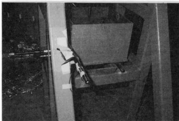
写真 27 破壊実験後の可動質量ストッパーの変形 Photo 27 Deformation of Moving Mass Stopper after Damage Test
