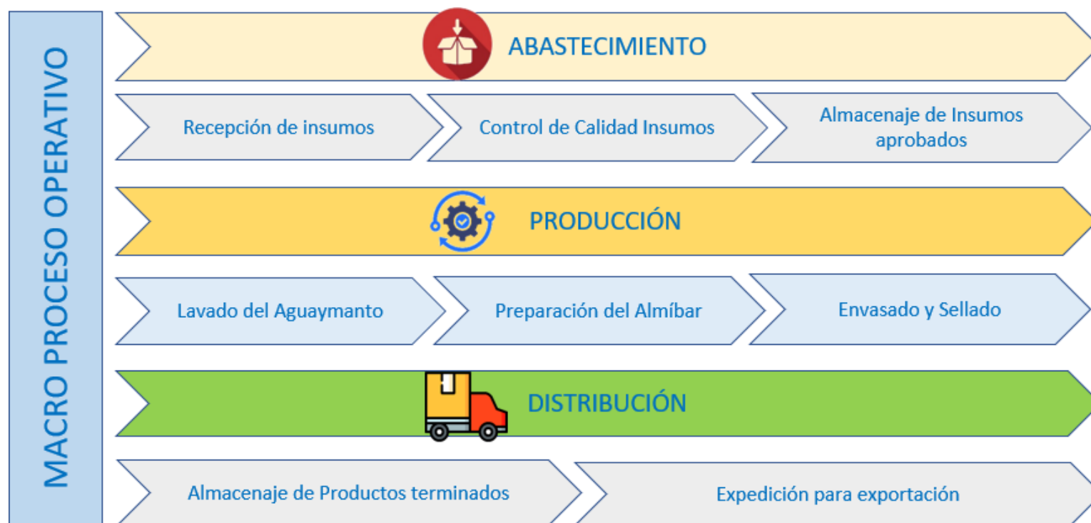
Figura 9.4. Mapa de Procesos de Operaciones para la elaboración de aguaymanto en conserva de almíbar
