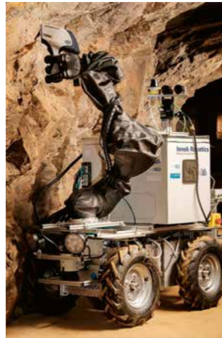
✕ Bergbauroboter Julius bei einer Messung mit einem RFA-Handgerät. Unter Tage. © TU Bergakademie Freiberg
