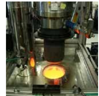
Abbildung 9: Der beheizte Strahler mit dem ausgefahrenen Stirlingmotor
