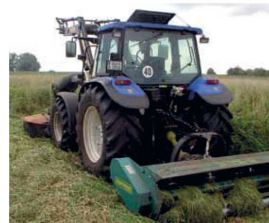
Abbildung 1: Kombination Trommelmäherwerk Mulcher
