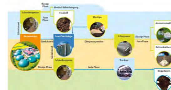
Abb. 1: BENAS-Biogasanlage mit Nährstoffrückgewinnung
