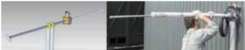
Abbildung 4a (links): Schematische Darstellung einer Probenahmelanze für Biogasfermenter. Das Außenrohr wird über eine Halterung und einen Kugelhahn in den Reaktor eingeführt. Die Probenahmekammer (Kopfteil, orange) wird von außen über ein Einsteckrohr (hier mit Griff) geöffnet und geschlossen.
