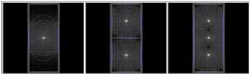
Abbildung 2: Darstellung der Feld- und Äquipotentiallinien des elektr. Feldes für unterschiedliche Elektrodenkonfigurationen (Quelle: Gezeichnet mit der Open-Source Software „2-D Electrostatics Applet“ [9]).
