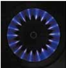
Abbildung 3: Coronaentladung in einem rohrförmigen Versuchreaktor. Das leuchtende Plasma tritt aus den Spitzen der sternförmigen Elektrode aus.
