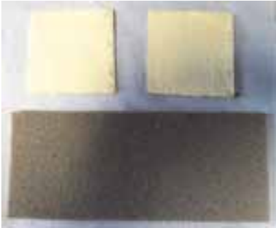
Abbildung 5: Mit Schwefel beladene Schaumproben (oben), unbeladener Legierungsschaum (unten).
