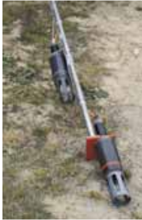
Abbildung 5a: Messlanze mit Messköpfen.
