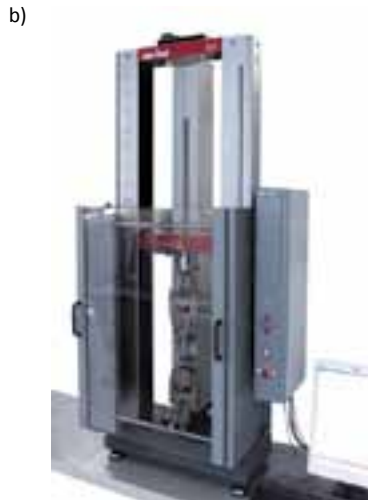
Abbildung 3: GFP-Messsystem (a) Fa. Etewe GmbH zur Bestimmung der Granulatfestigkeit und Material-Prüf-Maschine (b) Fa. ZWICK-ROELL (type: ZMART. PRO) zur Bestimmung der Brikettfestigkeit.
