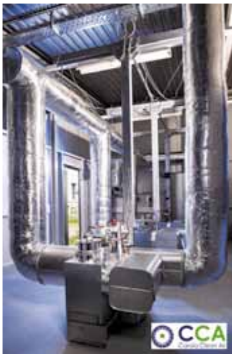
Abbildung 6: Teststand der CCA-Carola Clean Air zur Qualitätskontrolle und Dauerbetrieb der Carola-Abscheider.
