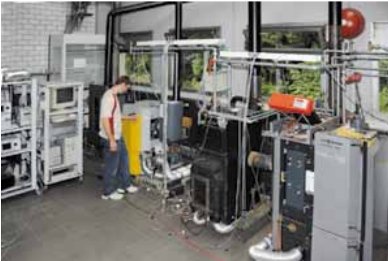
Abbildung 1: ISIS-Feuerungstechnikum mit den Feuerungsanlagen Vitolig 200 (Viessmann, Allendorf, re.) und Pelletti II (Ritter Energie- und Umwelttechnik, Karlsbad, li.), der Prozess-Steuerungs- und Messtechnik und dem SMPS/APS Feinstaubanalyzesystem (linker Bildrand).
