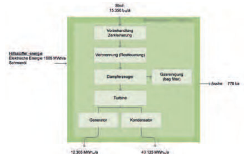
Abbildung 15: Schematische Darstellung der Prozessschritte für das Anlagenkonzept Strohheizkraftwerk (a: Jahr, el: elektrisch, FM: Frischmasse, h: Stunde, MWh: Megawattstunde, t: Tonne, th: thermisch)
