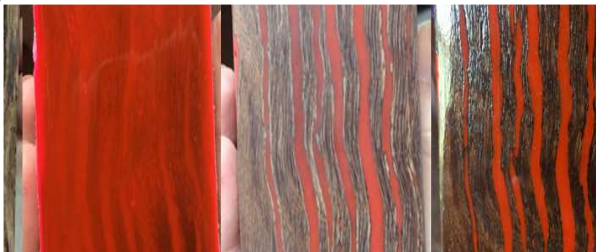
Figura 1. Fases da aplicação da resina Epóxi com pigmento em peça de madeira atacada por agente xilófago
