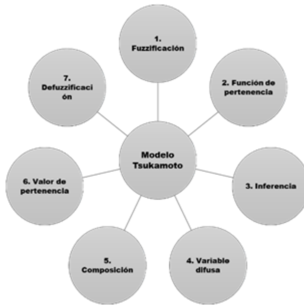
Fig. 5.5: Funcionamiento del sistema de inferencia Tsukamoto. Adaptado de (Adriyendi, 2018).
