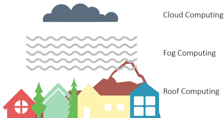
Figura 2.19: Ubicación de Roof Computing Fuente:IEEE Standard Association (Madanapalli, 2017)
