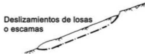
Ilustración 10 Deslizamiento traslacional de losas o escamas.
