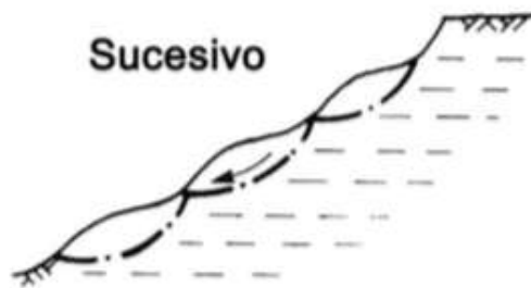
Ilustración 7 Deslizamiento rotacional sucesivo
