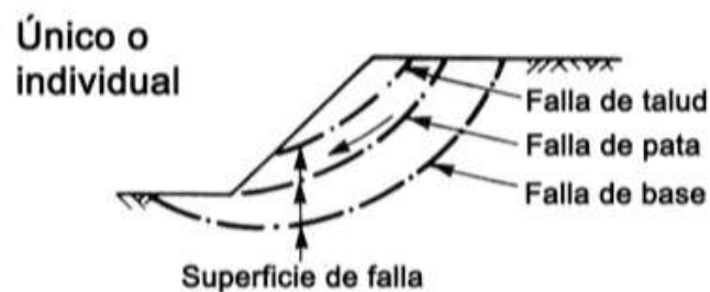
Ilustración 6 Deslizamiento rotacional individual
