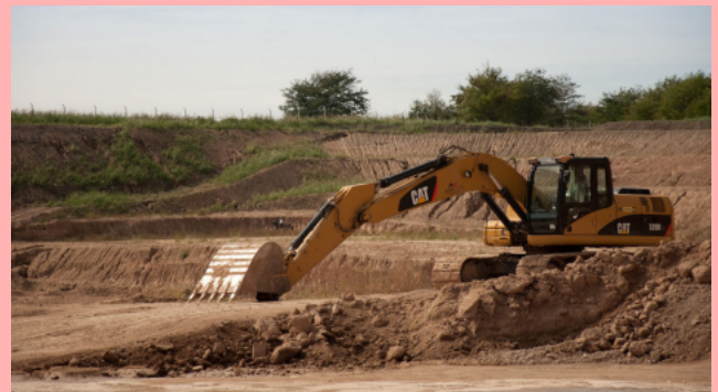
Figura 3. Extracción de tosca y arcilla en una cantera del partido de Marcos Paz. Foto Martín Schachner.
