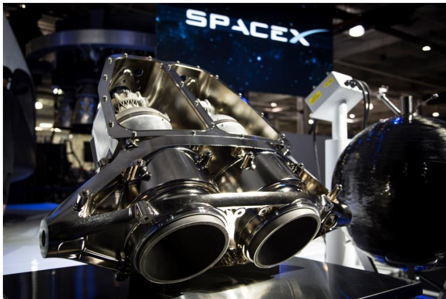
Slika 24. SuperDraco raketni motor izrađen 3D aditivnom tehnologijom
