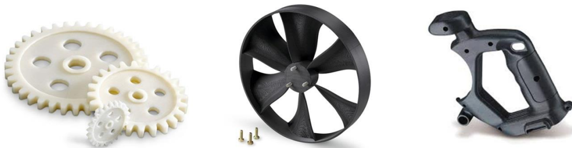
Slika 6. Prototip i gotovi proizvodi izrađeni FDM tehnologijom
