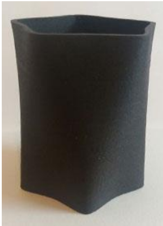
Slika 32. Proizvod tiskan Ebony (crno drvo) materijalom
