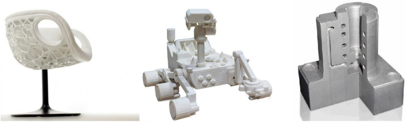
Slika 8. Prototipovi i proizvod izrađeni SLS metodom
