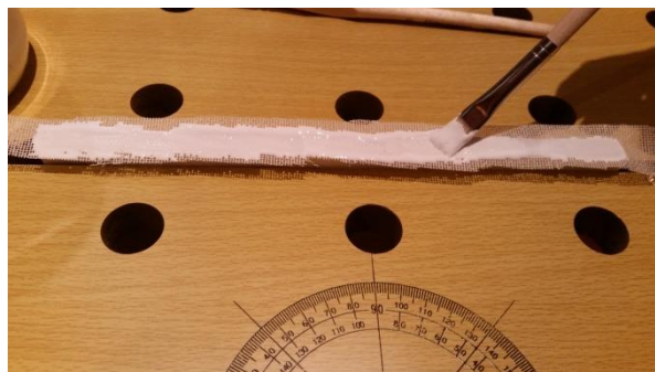
Slika 18. Lijepljenje gaze na hrbat knjižnog bloka
