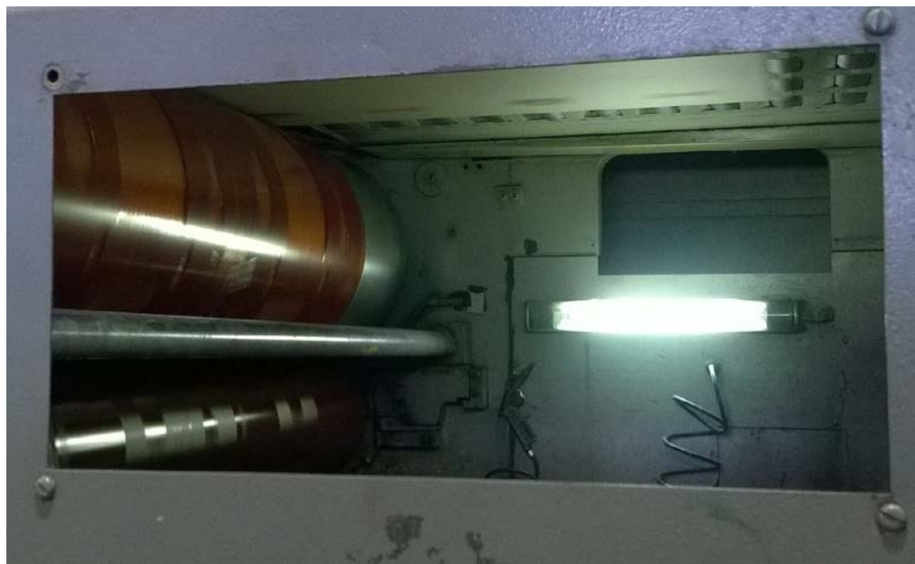
Slika 15 : Tiskovni agregat na stroju Bobst Flexo 160 Vision (S-2)
