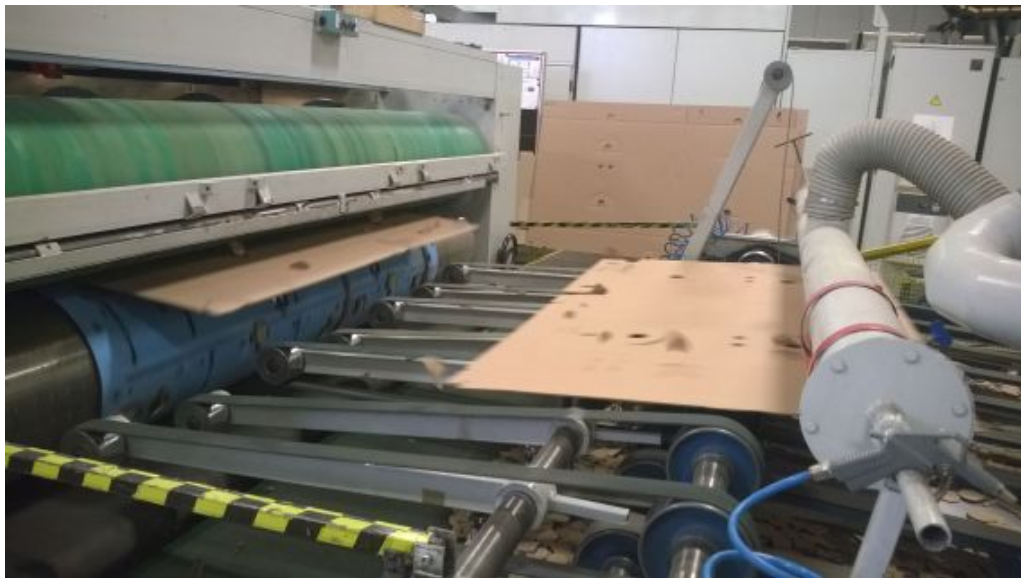
Slika 17 : Roto štanca na stroju Klett Sloter 3600 (Sloter)
