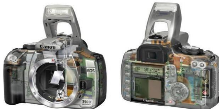
Slika 14. Presjek digitalnog fotoaparata, gdje se vidi senzor , računalo...
