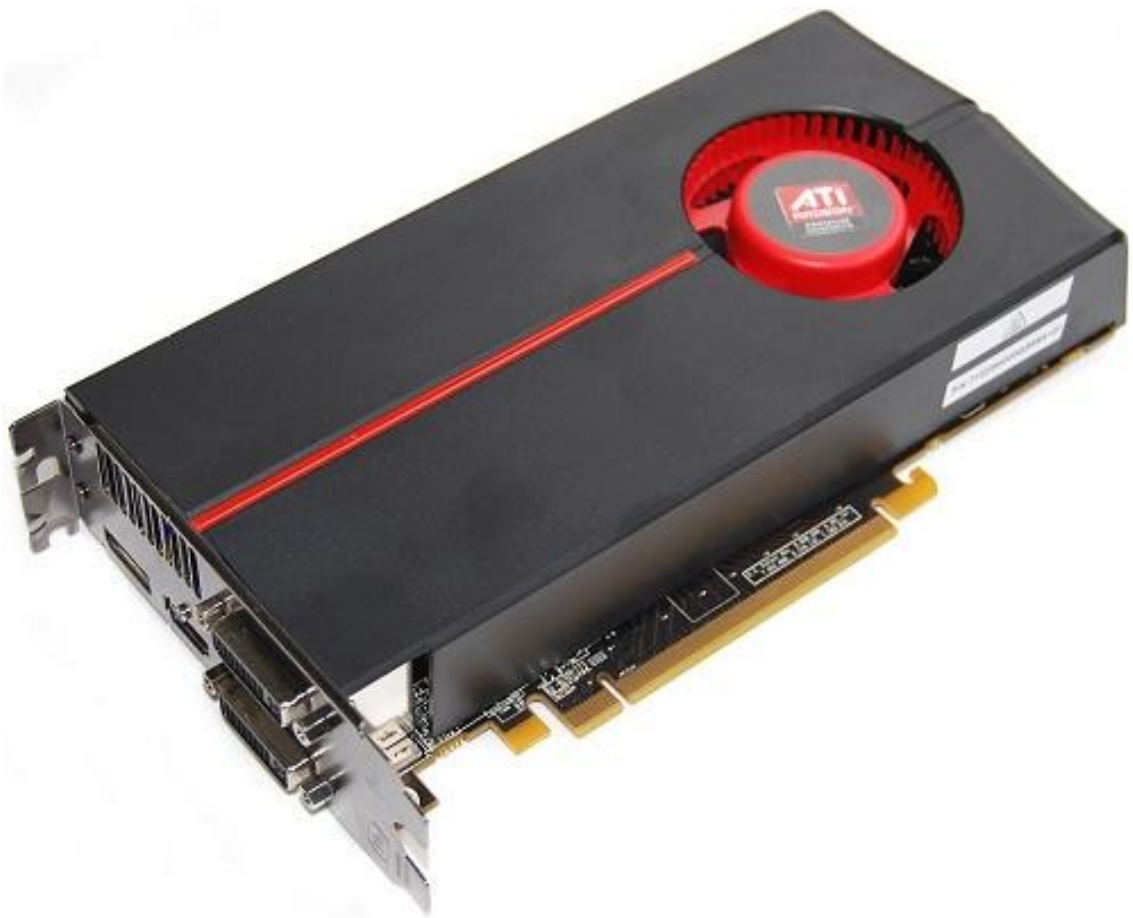
Slika 10. Grafička kartica ATI Radeon HD 5700 Series
