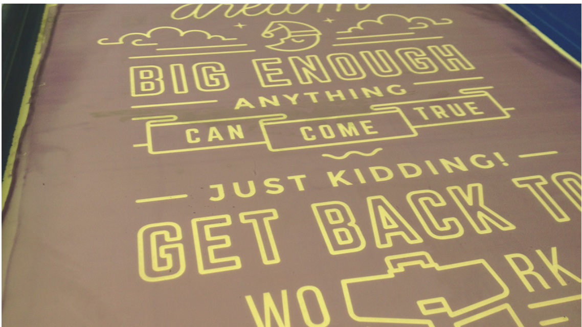
Slika 17. Tiskovna forma s mrežicom od 100lin/cm
