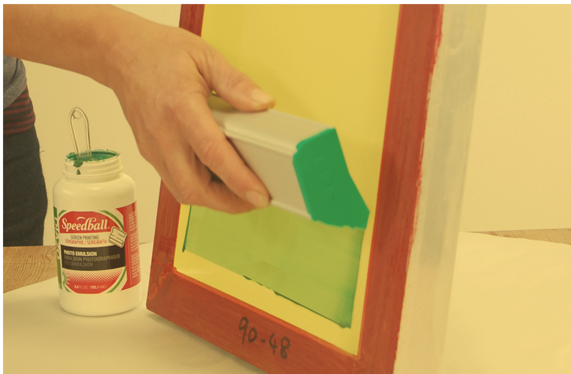
Slika 9. Nanos fotoaktivnog sloja na mrežicu za propusni tisak
