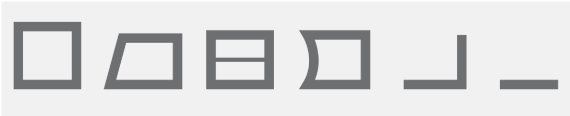
Slika 8. Presjeci metalnih okvira za propusni tisak
