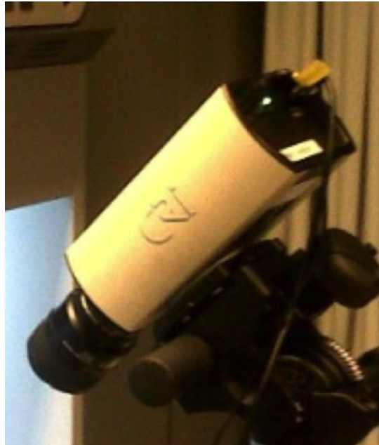
Slika 10. LCTF Nuance kamera pri korištenju
