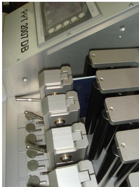
Slika 58: Smještaj e-putovnice u testnom uređaju
