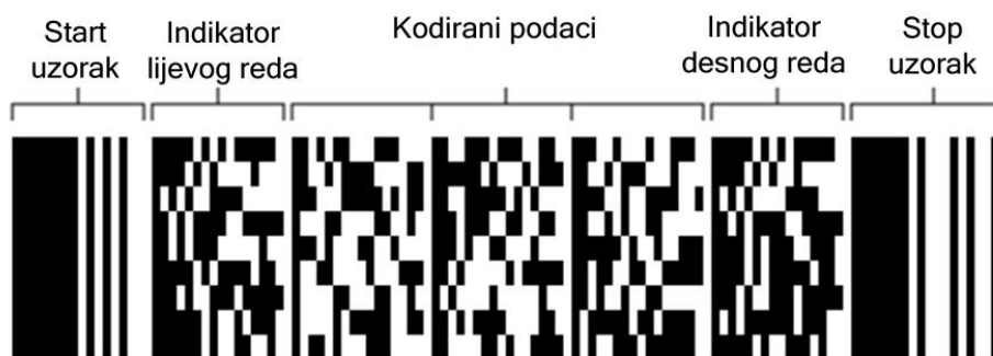
Slika 7: Prikaz dijelova 2D barkoda
