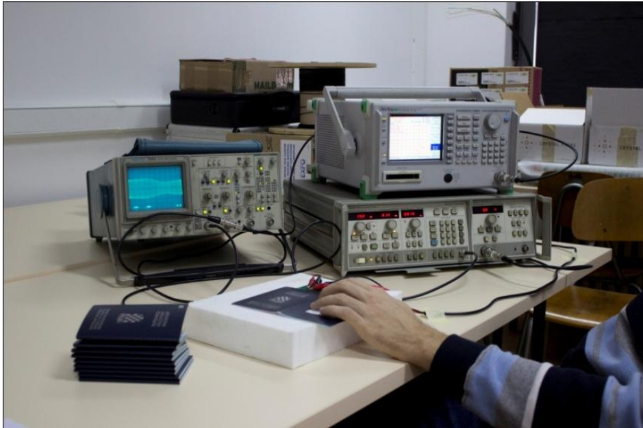
Slika 82: Mjerni postav za određivanje rezonantne frekvencije putovnica.
