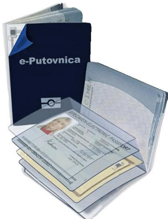
Slika 25: Prikaz smještaja transpondera unutar korica i unutar PC stranice
