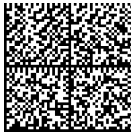
Slika 8: Primjer DataMatrix bar koda (sadrži tekst „Lorem ipsum dolor sit amet, consectetur adipiscing elit, sed do eiusmod tempor incididunt ut labore et dolore magna aliqua. Ut enim ad minim veniam“)
