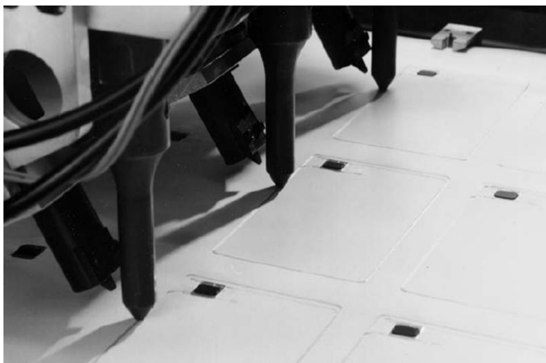
Slika 48: Proizvodnja zavojnice pametne kartice pomoću tehnike polaganja žice u polimernu podlogu. Na slici su vidljive sonotrode, elektrode za lemljenje (lijevo od sonotroda) i 4 dovršena transpondera (izvor: AmaTech GmbH & Co. KG Pfronten)
