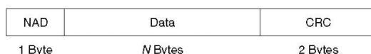
Slika 41: Struktura standardnog okvira za prijenos aplikativnih podataka u oba smjera između čitača i kartice Tipa B. Vrijednosti x5h (05h, 15h, 25h, . . . E5h, F5h) NAD-a (node address) subjekt su antikalizijskih naredbi, kako bi pouzdano izbjegla zabuna s aplikacijskim naredbama
