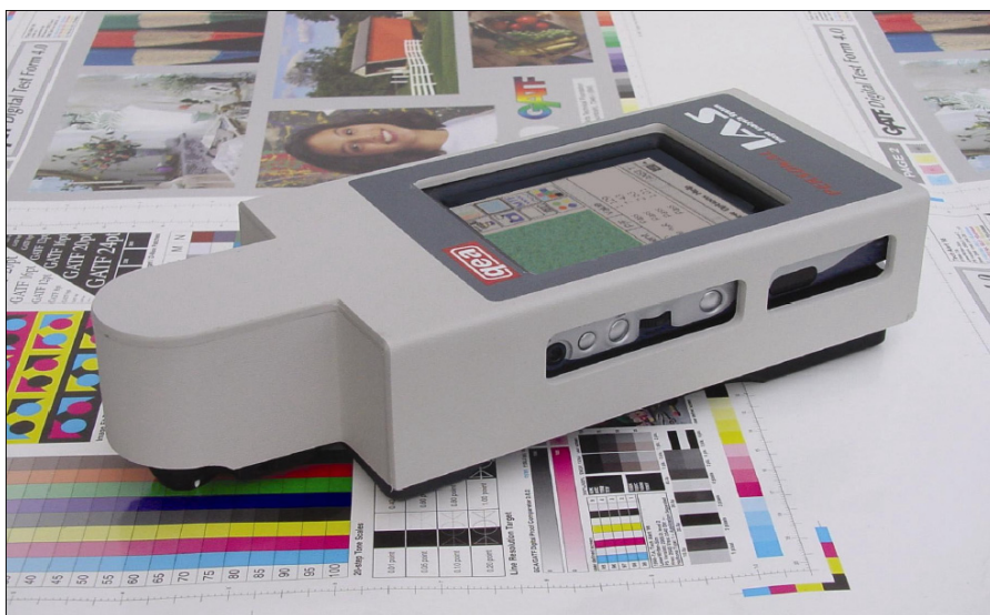
Slika 38 Anlizator slike, Personal Image Analysis System-IAS, korišten u ovom radu.
