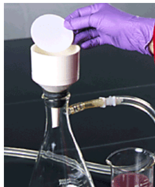
Slika 30 - Buchnerov lijevak spojen na vakuum
