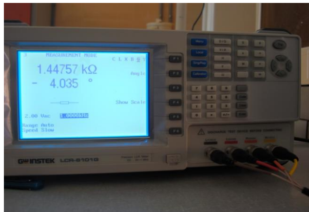
Figura 3.9: Medidor LCR-8101G de freqüências de 20,0 Hz a 1,00 MHz utilizado para medir a impedância a freqüência fixa e para fazer espectroscopia de impedância nos sensores.
