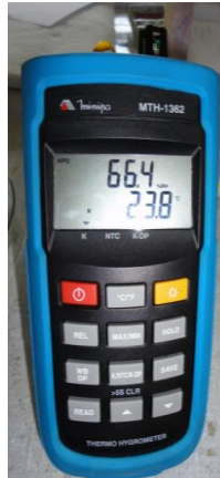
Figura 3.8: Medidor de umidade MTH-1362 da Minipa, com um termopar, usado para medidas de temperatura e umidade próximas ao sensor em estudo.
