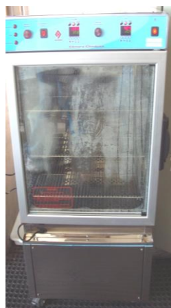
Figura 3.7: Câmara climática Q315C21 utilizada para gerar umidades relativas entre 30 RH% e 95 RH% e temperaturas entre 20 °C e 50 °C.
