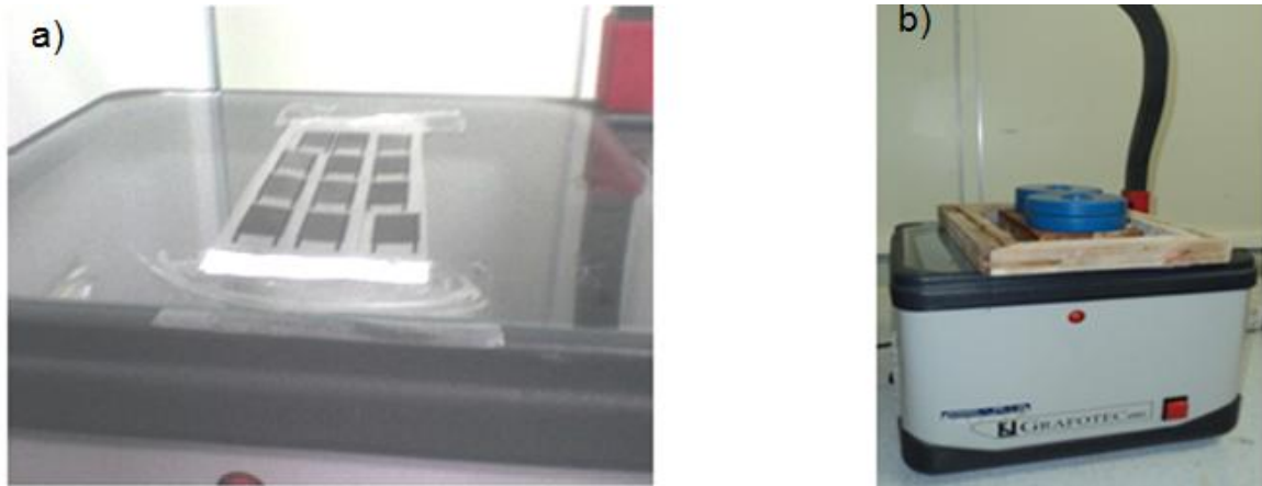
Figura 3.4: a) Fitolito fixado sobre o vidro do retroprojektor. Os contatos interdigitados (em preto) no acetato impedem a chegada de luz em parte da tela formando uma sombra na mesma. b) Retroprojektor, fotolito, tela virada para baixo, papel preto e peso para garantir um contato firme sobre o retroprojektor.
