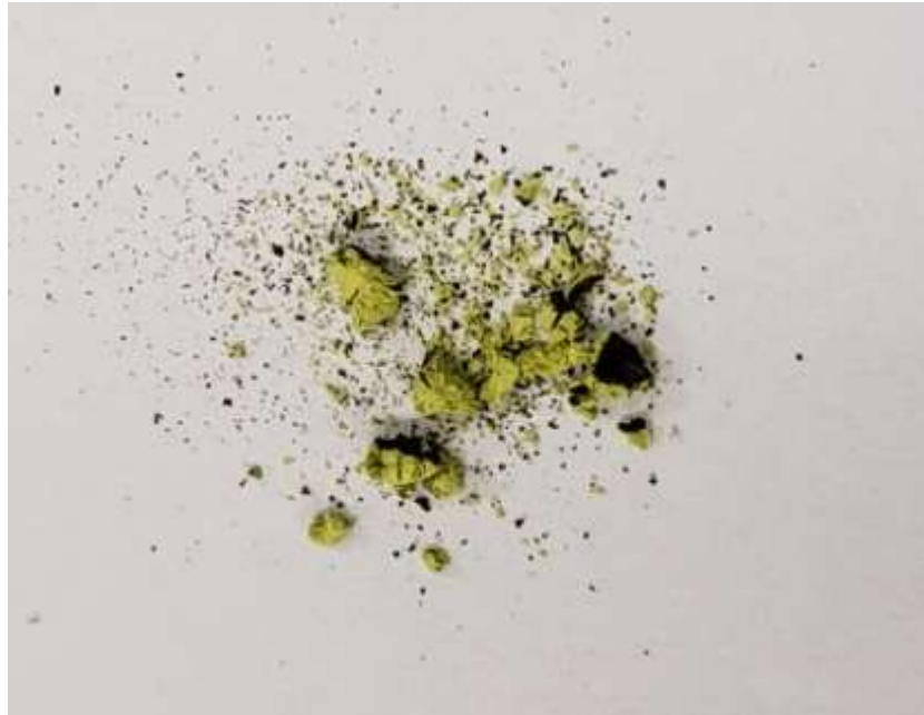
Figura 48. Amostra decomposta após ensaio de oxidação isotérmica realizado por 62 horas em temperatura de 1.200°C na amostra revestida a 1100°C por 12 horas.
