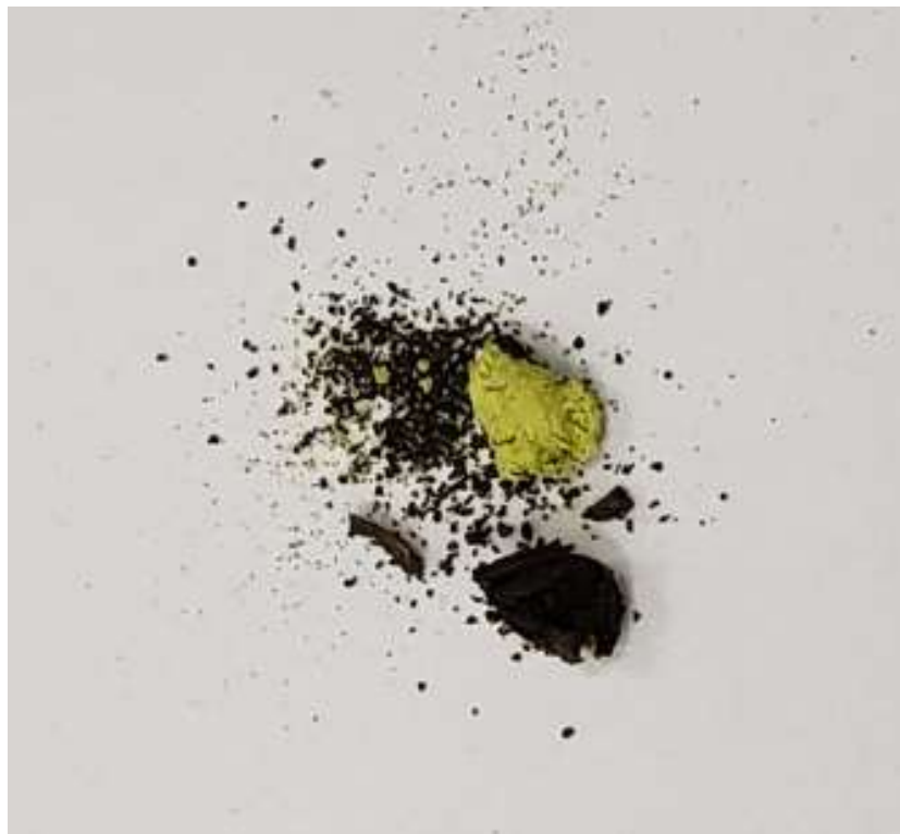
Figura 50. Amostra decomposta após ensaio de oxidação isotérmica realizada por 62 horas em temperatura de 1200°C na amostra revestida a 1200°C por 36 horas.
