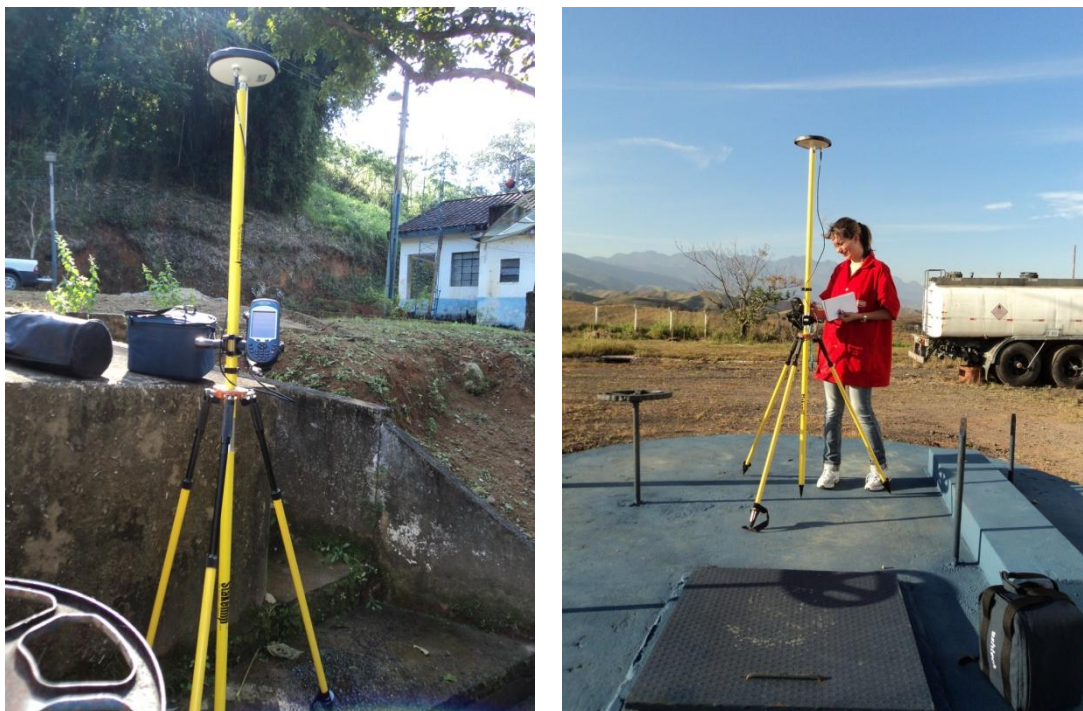
Figura 31. Instalação do DGPS base e móvel.
