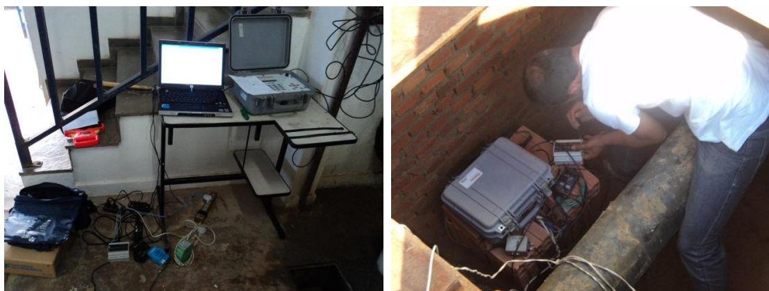
Figura 27. Medidor de vazão ultrassom e sistema de aquisição de dados em Cruzeiro.
