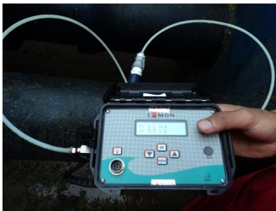
Figura 33. Medida de nível d'água do reservatório de Cruzeiro utilizando datalogger .
