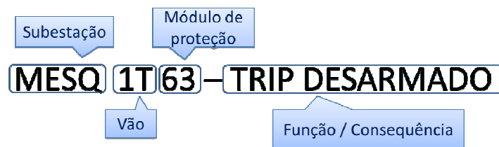
Figura 4.10 Exemplo de alarme de proteção de transformador, configurado no sistema de supervisão e controle da Cemig
