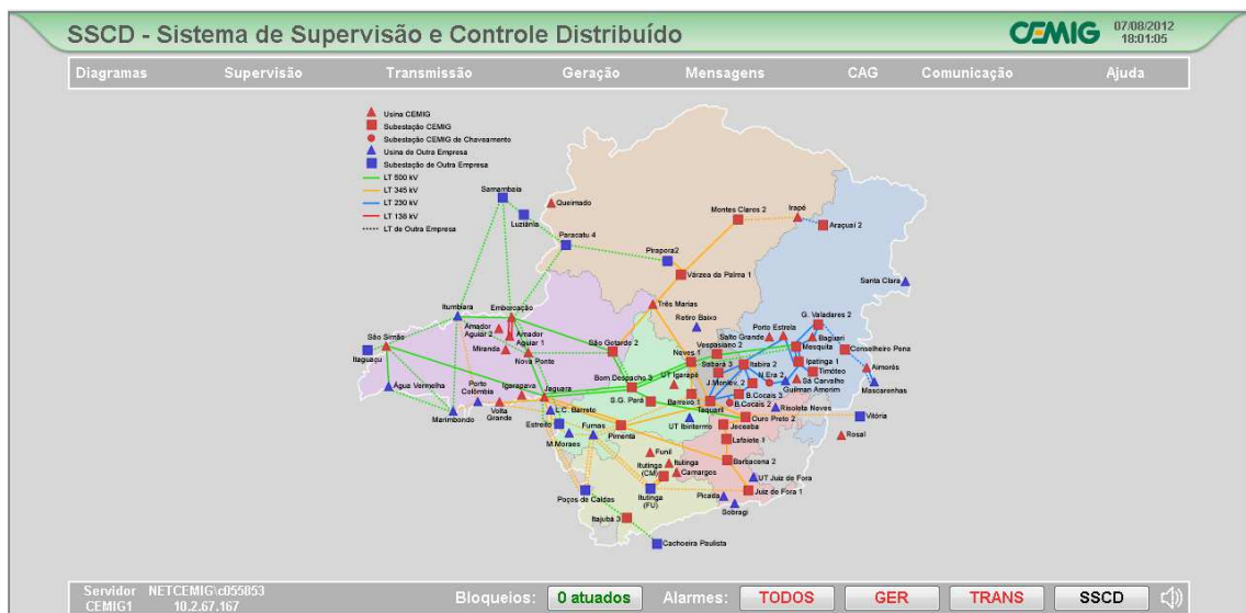
Figura 1.4 Interface de acesso ao Sistema de Supervisão e Controle Distribuído (SSCD)
