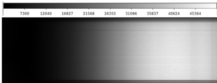
Figura 10 – Uma das imagens de flat field utilizadas na redução dos dados. A escala no topo da imagem indica a contagem de fótons.
