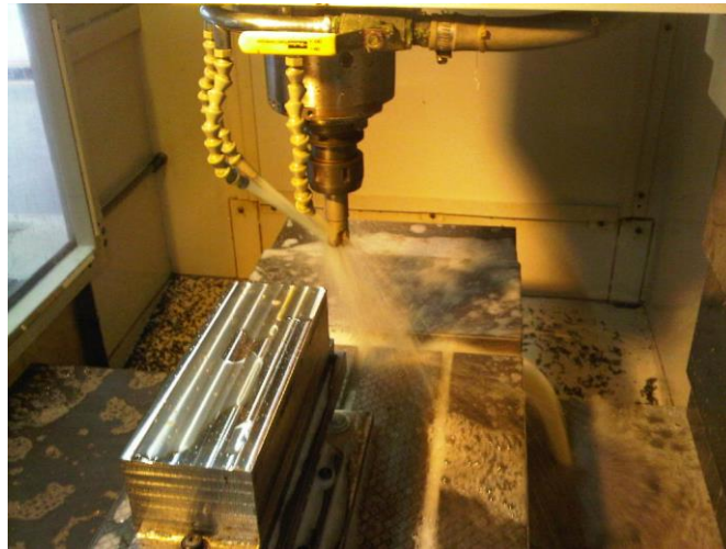
Figura 4.5 – Execução do fresamento.
