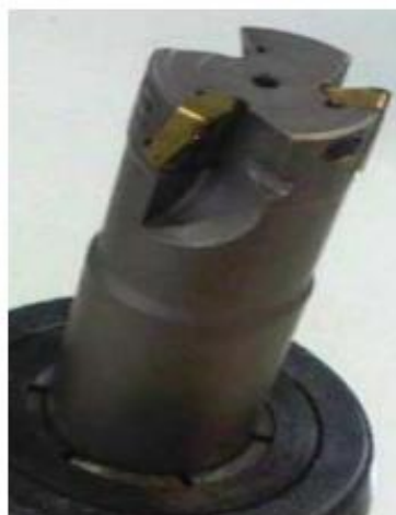
Figura 4.3 - Cabeçote com insertos para o fresamento de topo.
