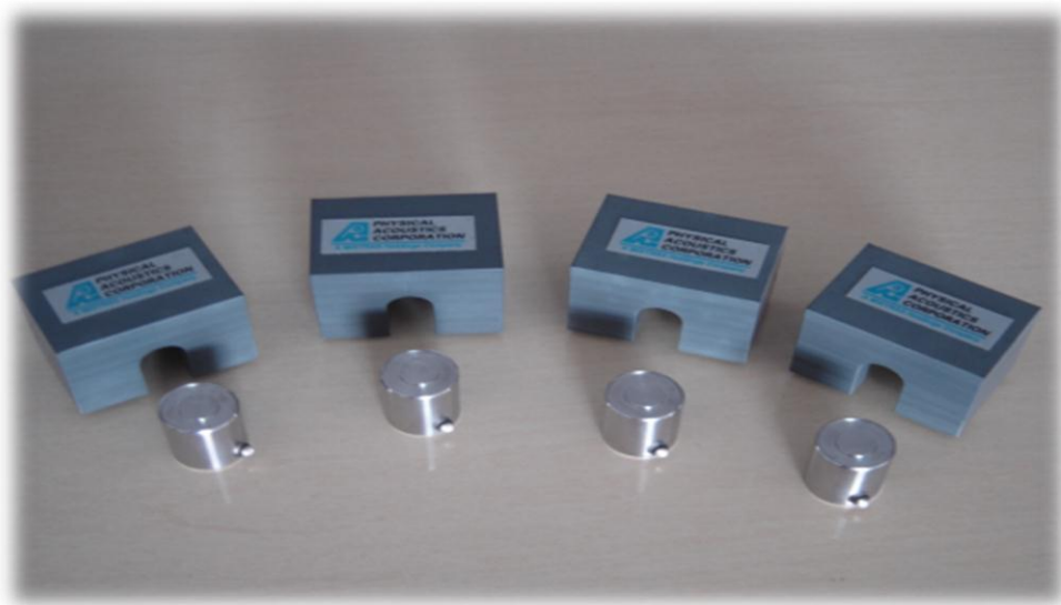
Figura 5.4: Sensores PAC S9208 com seus respectivos prendedores magnéticos para fixação nas paredes do tanque.
