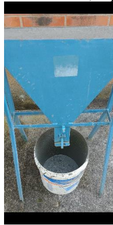
Figura 33: Ensaio no estado fresco: a) Espalhamento, b) Funil V, c) Caixa L
