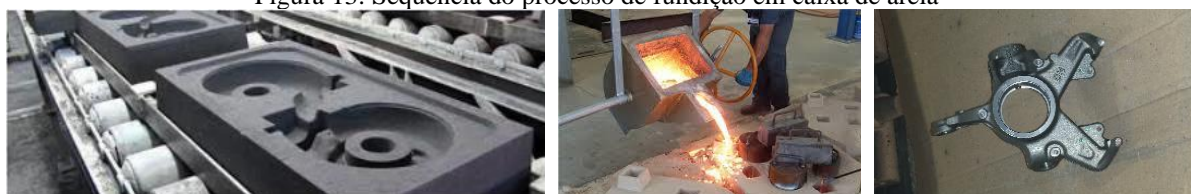
Figura 13: Sequência do processo de fundição em caixa de areia
