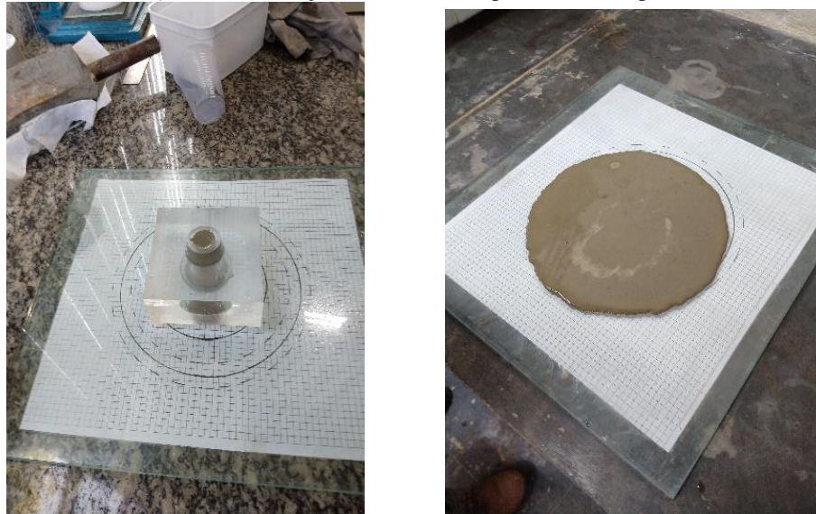
Figura 31: Realização do ensaio de espalhamento da pasta
