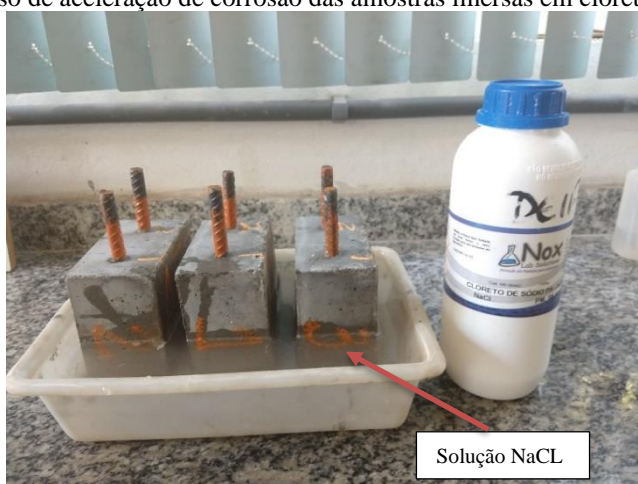
Figura 72: Processo de aceleração de corrosão das amostras imersas em cloreto de sódio
