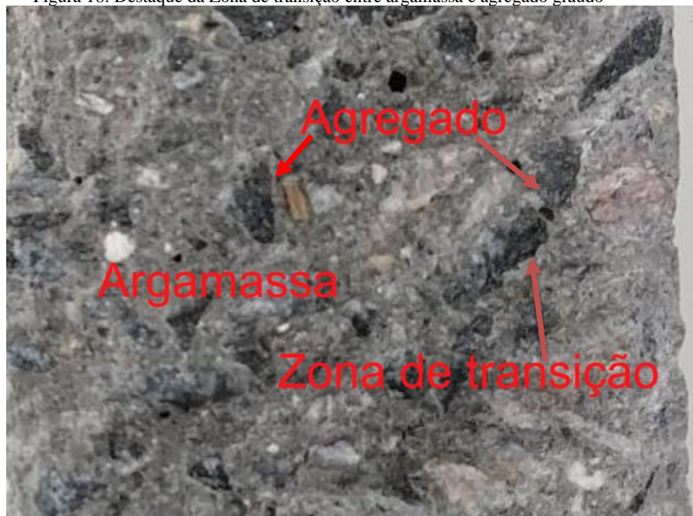
Figura 18: Destaque da Zona de transição entre argamassa e agregado graúdo
