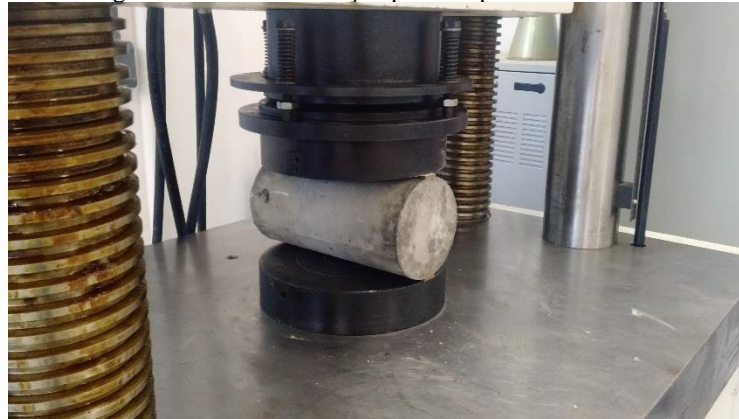
Figura 38: Ensaio de tração por compressão diametral
