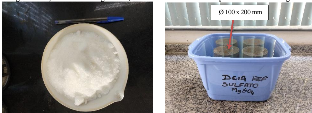
Figura 39: a) Sulfato de Magnésio b) Amostras imersas na solução de sulfato de magnésio
