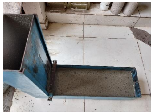
Figura 33: Ensaio no estado fresco: a) Espalhamento, b) Funil V, c) Caixa L
