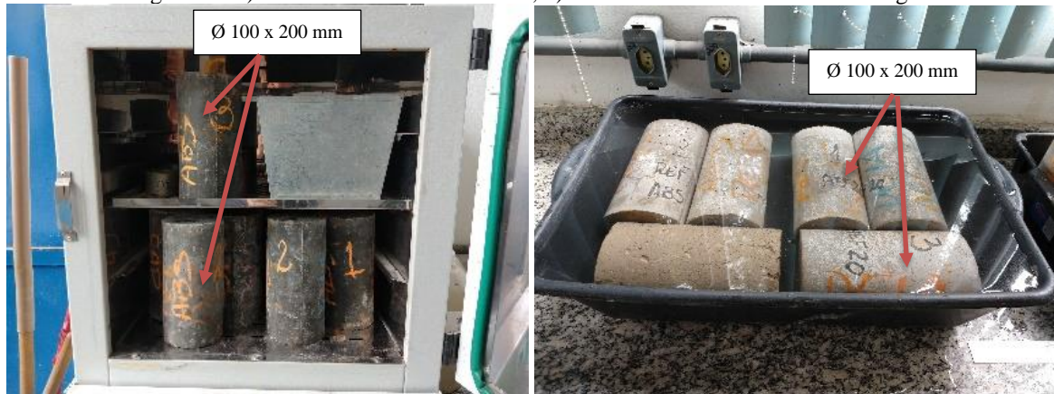
Figura 36: a) Amostras na estufa a 105°C; b) amostras totalmente imersas em água
