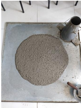
Figura 33: Ensaio no estado fresco: a) Espalhamento, b) Funil V, c) Caixa L
