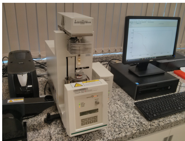
Figura 3.18: Equipamento utilizado nas medidas de TGA e síntese. (Fonte do próprio autor)
