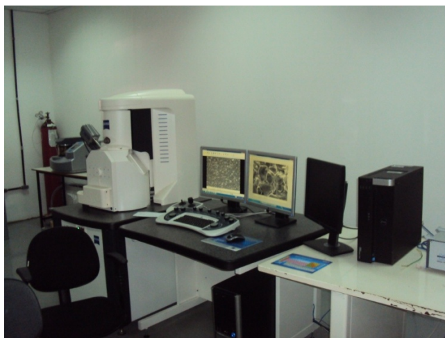
Figura 3.21: Equipamento utilizado nas medidas morfológicas por MEV. (Fonte do próprio autor)
