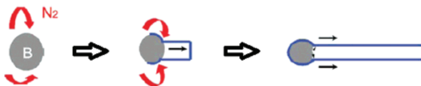
Figura 2.12: Ilustração do modelo proposto para o crescimento dos NTN B 's. (Extraído de [14])
