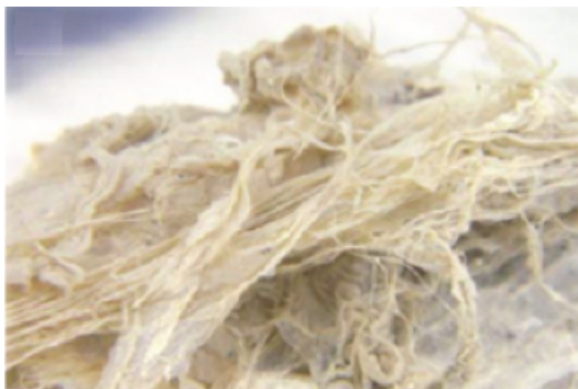
Figura 2.2: Material fibroso composto por fios de NTN B 's (Extraído [23])
