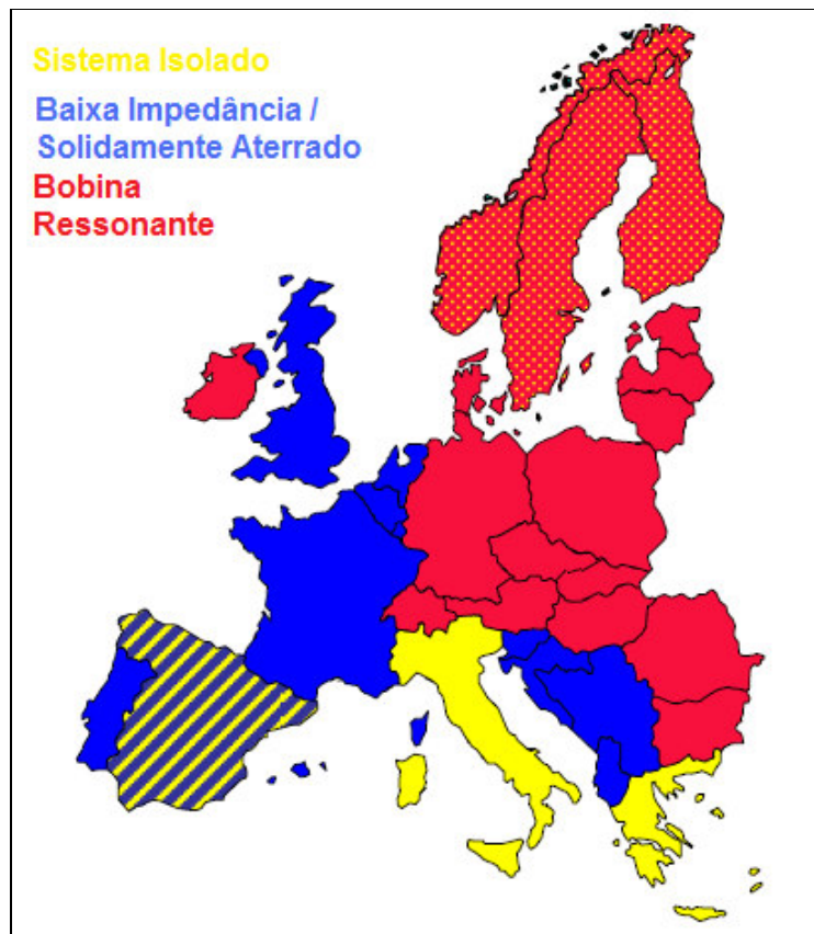
Figura 2 – Evolução dos Métodos de Aterramento do Neutro Utilizados na Europa [5].
