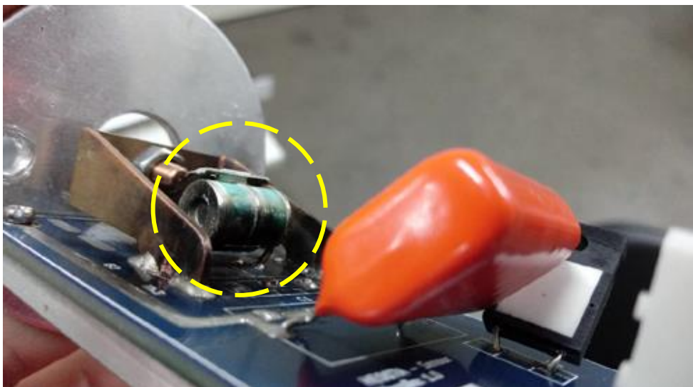
Figura 6-15 – Dano causado ao centelhador após 40 kA.
