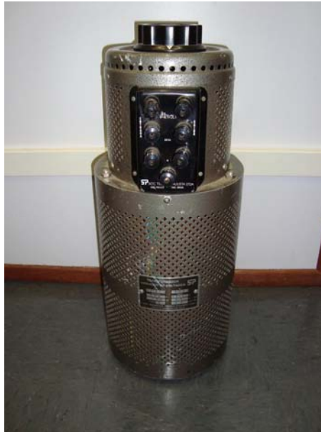
Fig. 5.7 - Equipamento utilizado para variar a tensão de entrada.
