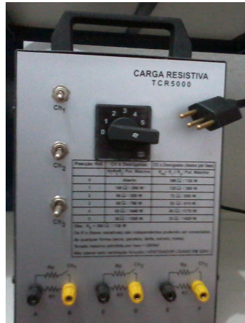
Figura 3.4: Carga resistiva trifásica do setup experimental de GS de polos salientes.
