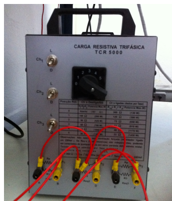
Figura 3.26: Carga resistiva trifásica do setup experimental de GS de polos lisos.
