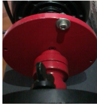
Figura 3.6: Inserção de parafuso no disco de aço carbono no setup experimental com GS de polos salientes.
