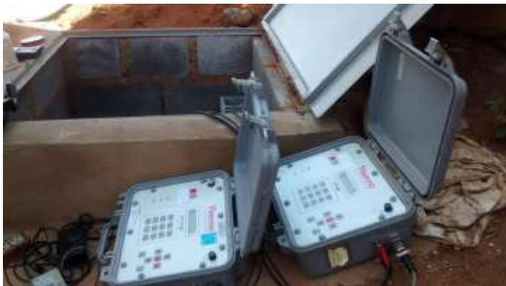
Figura 32 - Medidores de vazão ultrassônicos em R3
