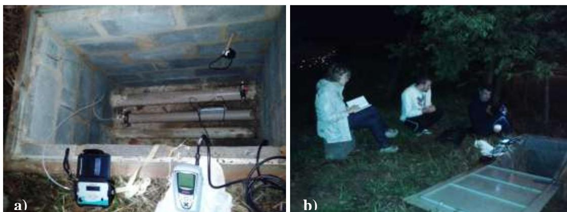
Figura 42 - a) Medidores de pressão e vazão instalados na entrada do sistema; b) Equipe de trabalho durante ensaio da madrugada (maio/2015)
