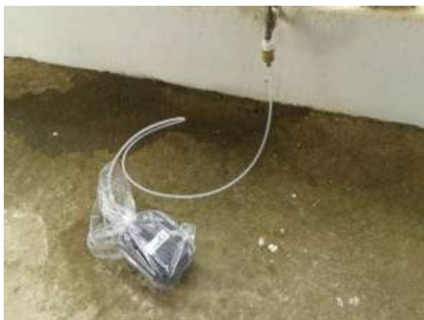
Figura 27 - Medidor de pressão instalado em uma das residências monitoradas
