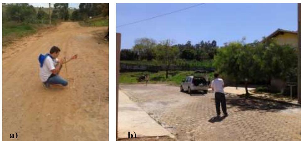
Figura 28 - a) Medição do cavalete até ao centro da rua; b) medição do centro da rua até o local de coleta de dados topográficos, em Cambuí, MG (outubro/2014)
