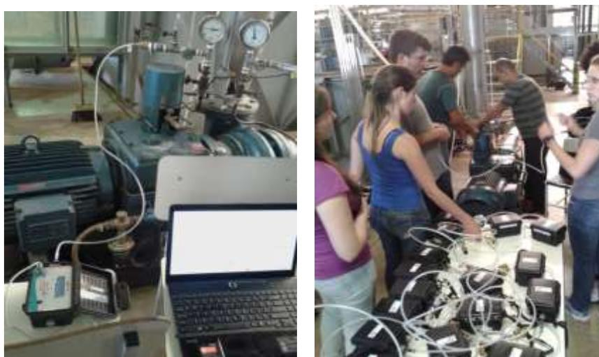
Figura 22 - Testes de calibração dos medidores de pressão
