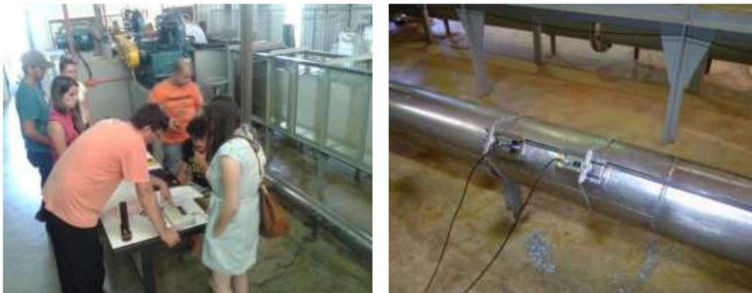
Figura 21 - Teste de bancada e configuração do medidor de vazão ultrassônico
