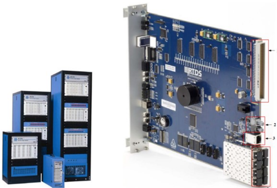
Figura 5 – Tecnologia RTDS. Equipamentos modulares e placa GTWIF com quatro tipos de interfaces externas. fonte manual RTDS
