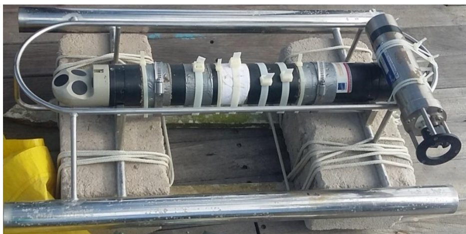
Figura 13: Arranjo da estrutura de suporte e os equipamentos ADP (maior; perfilador de corrente) e CT (menor; termococondutivímetro) para instalação sobre o leito do estuário.
