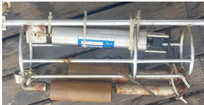
Figura 15: CTD (Condutividade, Temperatura e Profundidade) instalado na superfície.
