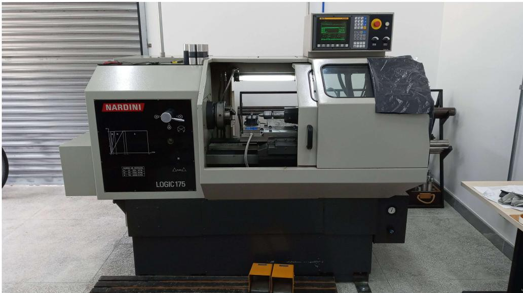
Figura 5.5: Setup para o torneamento duro dos corpos de prova (autoria própria)
