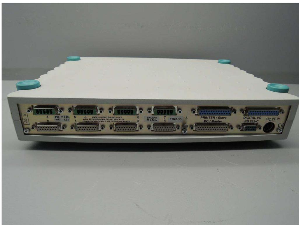
O Spider8-01/DC, da HBM®, possui 8 canais para aquisição de dados, numerados de 0 a 7 (Figura 5.14). Em cada canal, há um terminal de 15 pinos, que pode ser conectado em 1/4 de ponte, 1/2 ponte e ponte inteira. Os *strain gages* 1, 2 e 3, de cada roseta foram ligados aos canais 0, 1 e 2 do aquisitor de sinais. A Figura 5.15 mostra o esquema de ligação para cada canal do Spider, considerando a conexão do tipo 1/2 ponte. As letras A e B são referência às amostras utilizadas para conexão.
