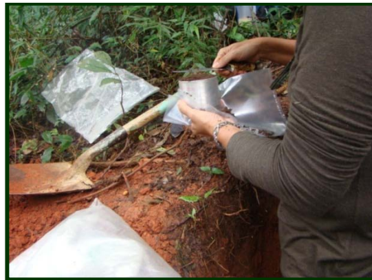
Figura 4.15. Coleta e limpeza de amostra indeformada nas catenas da sub-bacia do ribeirão José Pereira.
