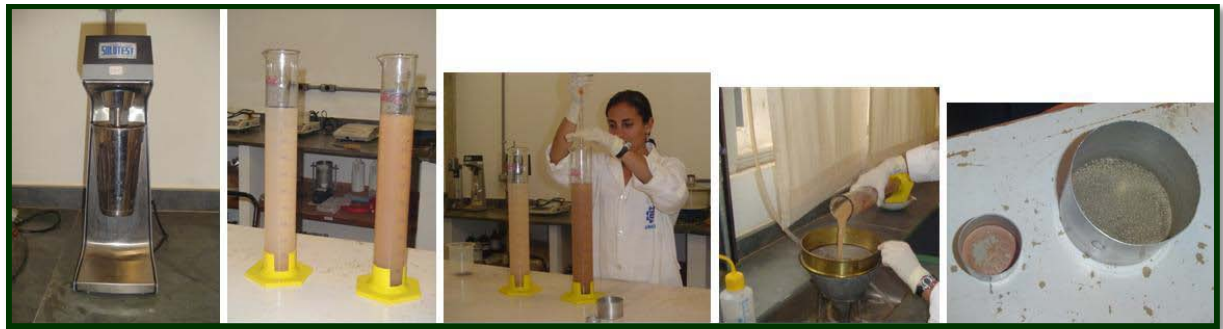
Figura 4.18. Sequência laboratorial para quantificação das frações texturais e determinação do índice de floculação.
