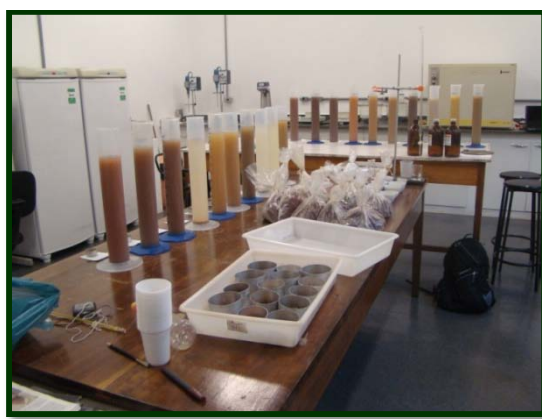
Figura 4.19. Vista geral do laboratório de Solos da UNIFEI: análises de textura e densidade de partículas.
