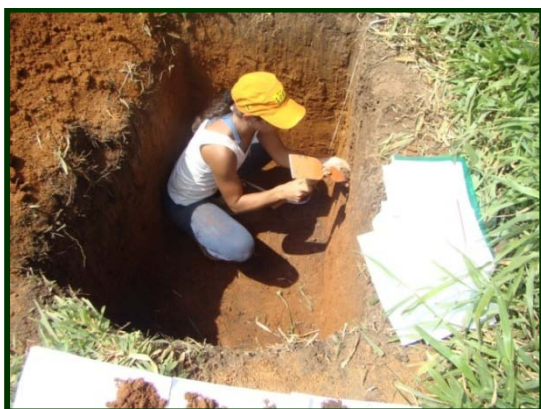
Figura 4.16. Coleta de amostra deformada nas catenas da sub-bacia do ribeirão José Pereira
