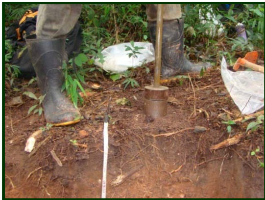
Figura 4.15. Coleta e limpeza de amostra indeformada nas catenas da sub-bacia do ribeirão José Pereira.
