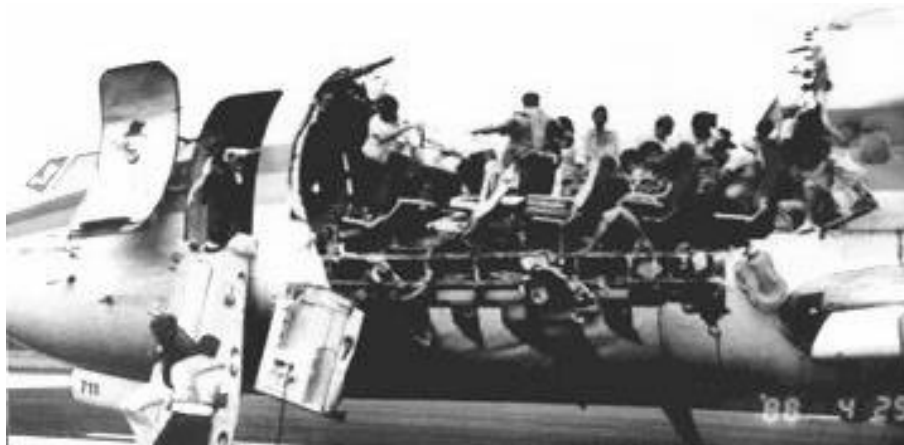
Figura 4.1 - Acidente do voo Aloha Airlines 243, em 29 de abril de 1988, devido à corrosão, insuficientemente controlada por manutenção (BALAGEAS, 2006).
