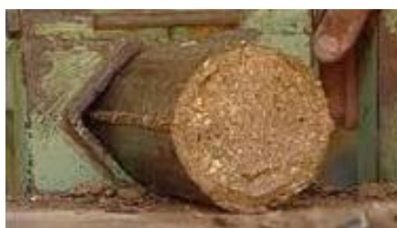
d) CDR em briquetes 3 cm diâmetro * 3-5 cm comprimento
