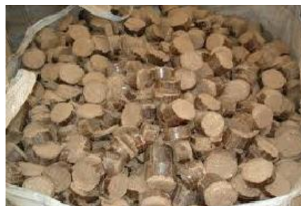
b) Eucalipto em briquetes 3 cm diâmetro * 3-5 cm comprimento
