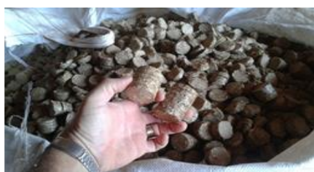
c) Miscanthus em briquetes 3 cm diâmetro * 3-5 cm comprimento
